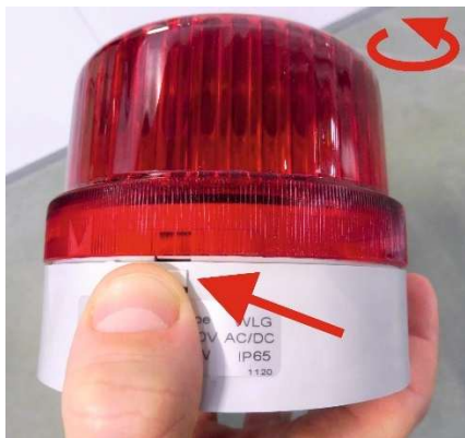
Fot. 4-16. Demontaż klosza lampy sygnalizacyjnej.
