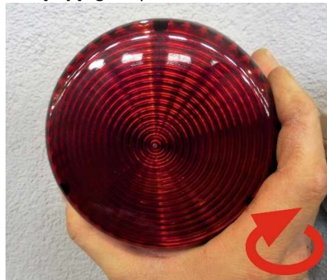
Fot. 4-24. Montaż klosza.
