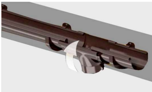
Fot. 4-30. Montaż leja spustowego.
