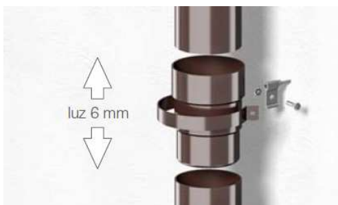
Fot. 4-36. Łączenie odcinków rur.
