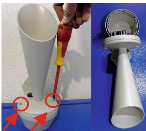
Fot. 4-9. Demontaż buczka.
