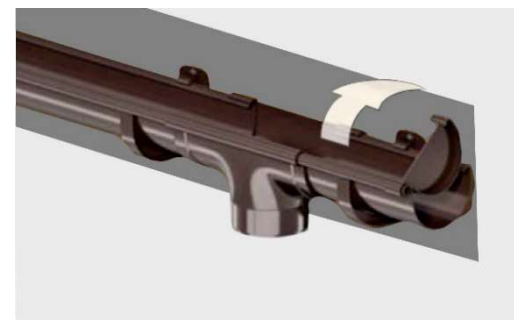
Fot. 4-34. Montaż denka uniwersalnego.
